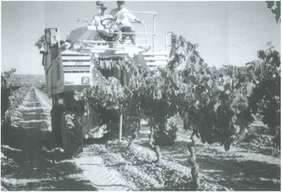
26. Màquina de collir o veremar. Arreplega el gra i el destria de la fulla o pampa.
