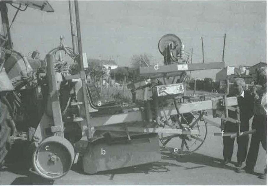
24. Màquina per plantar els ceps que consta de: a) Seient del plantador. b) Pala que obre el solc on es dipositen els plançons. c) Roda de nivell de profunditat. d) Plataforma superior on es dipositen els plançons a distribuir. e) Roda on cauen les plantes per dipositar-les al solc. f) Guies en forma de (Y) que colguen el plançó.
